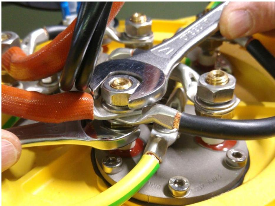
17.2 Пожалуйста, помните о правильном расположении нагревательных элементов. Расположение можно отследить глядя на положение термокарманов (отмечены стрелочками на изображении ниже).
